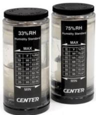
Погрешность 1% при 25°C (предполагается наличие температурной стабильности во время измерений). Значение влажности: 32,8%; 75,3%. Размеры колбы: 39 мм (диаметр) × 83 мм (высота). Измерительное отверстие меры (диаметр входного отверстия колбы) - 15 мм.
